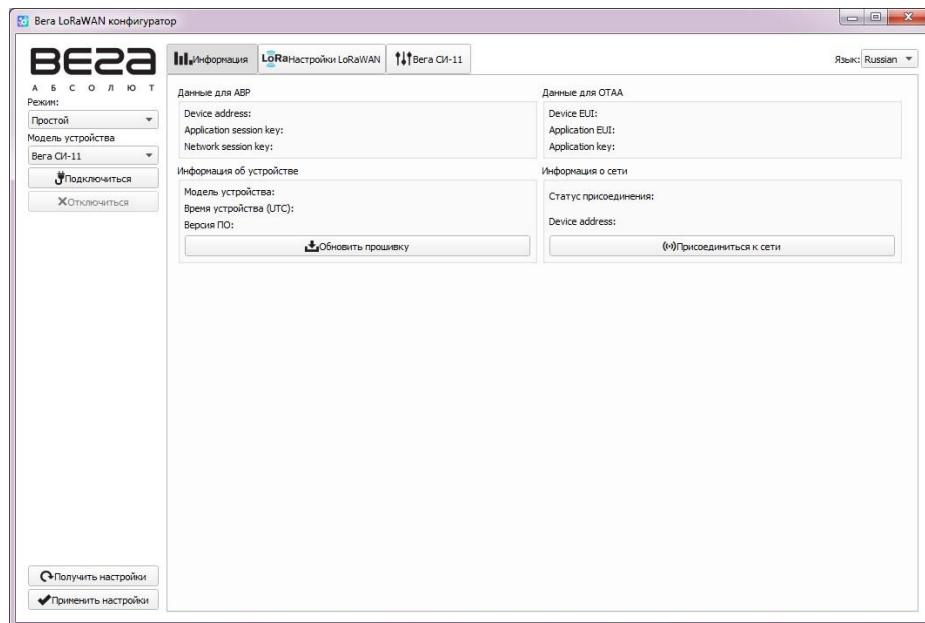
3. Нажать кнопку «Обновить прошивку». Появится окно с вопросом «Устройство еще не подключено. Обновить прошивку после подключения?». Выбрать «Yes» и указать путь к файлу исходного кода программы (прошивки), который должен иметь расширение \*.vbf
