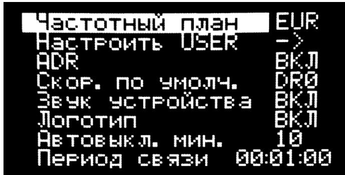
Частотный план – выбор стандарта сетки частот. EUR – европейский частотный план. RUS – российский частотный план, USER – произвольный частотный план.
