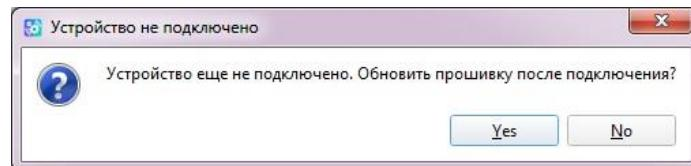
4. Подключить тестер сети к персональному компьютеру через USB порт и включить тестер сети. По включению тестера запускается программа загрузчик (программа обновления прошивки), которая показывает свою активность надписью «BOOT».
