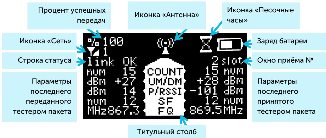
В отличие от остальных экранов, рабочий экран 2 выводит информацию только о последнем сеансе связи. Накопленными данными здесь является коэффициент PER и общее количество принятых/переданных пакетов.
